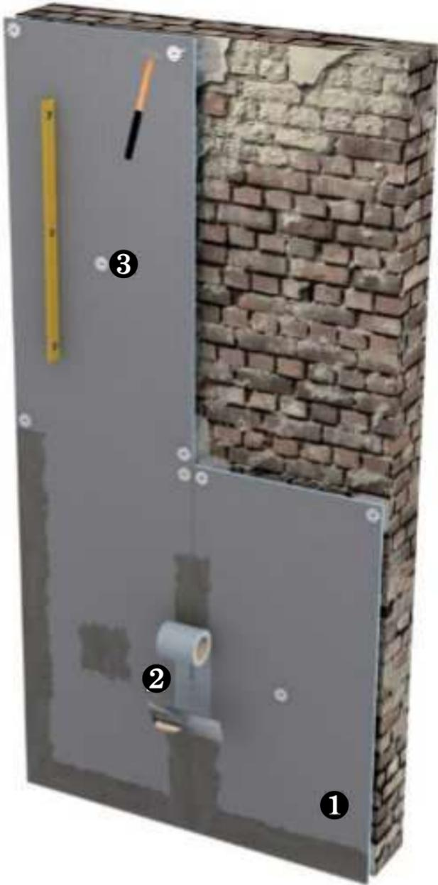
古い凹凸のある壁面でも、GL工法で簡単にモルタル平面が仕上がります。
