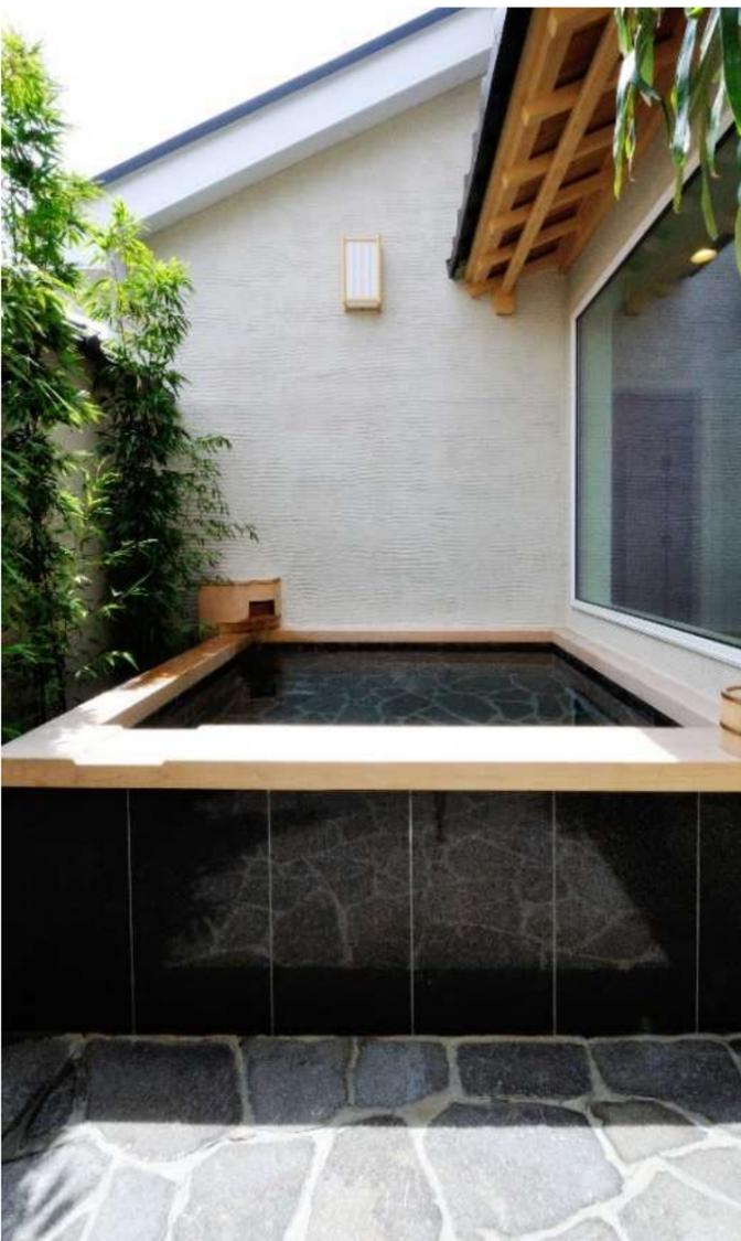
和風木造住宅の2階バルコニーに設置されたウェディボード製の風呂。下地には全て軽い素材のウェディボードが使われています。工場で加工して搬入し、現地にて仕上げ加工をします。
