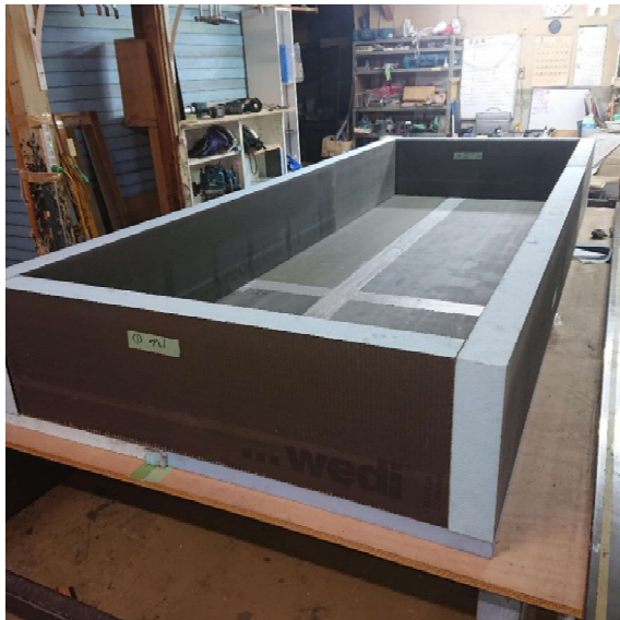
厚み100mm wedi board 使用 (外寸:1,550×3,850×550mm)
